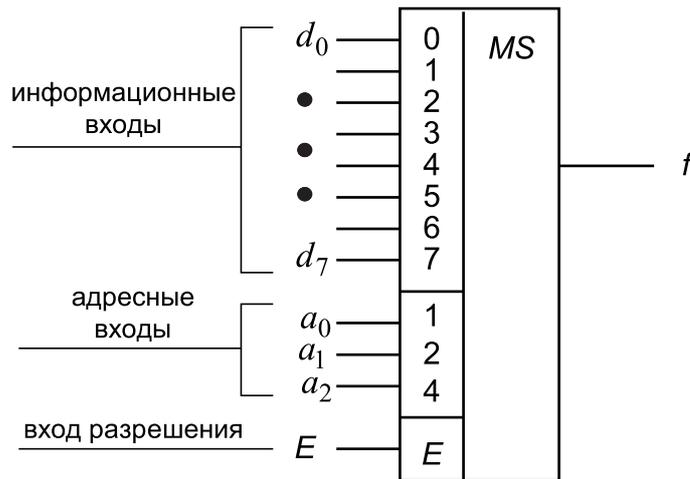
Рис. 4.3 – Полный мультиплексор 8–1
